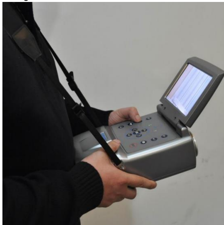
Abb. 14. An den Hosenträgern befestigte Kamera.
