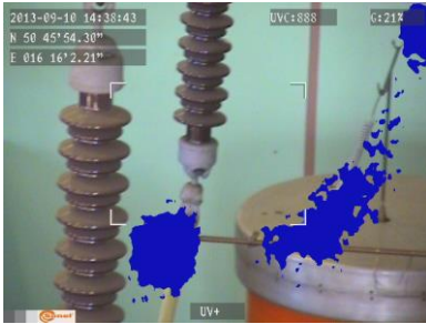
Abb. 3,4. Koronaentladung unter Laborbedingungen.
